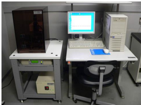
図 1 超微小押し込み硬さ試験機の外観写真
