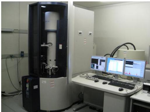
図 1 球面収差機能付 STEM の外観
