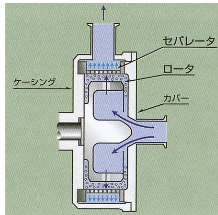
図2 ビーズミル式粉砕機の処理室の構造
