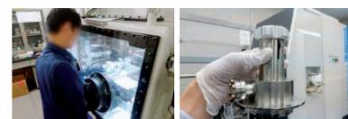
試料調整用のグローブボックス（左）と大気非曝露ベッセル（右）
