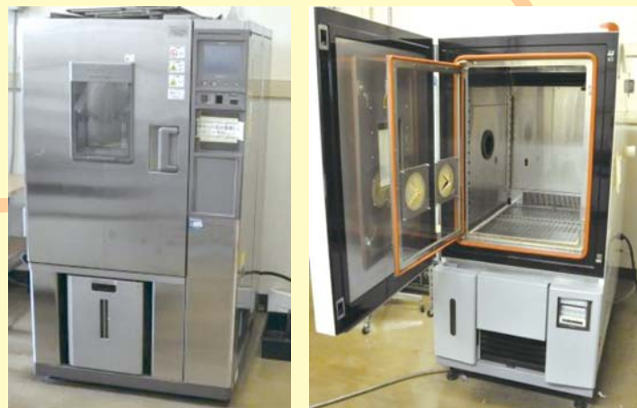
環境試験に使用可能な恒温恒湿器 (右の写真の機種は前扉に操作孔を備えている)
