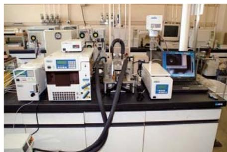
超臨界二酸化炭素反応装置
