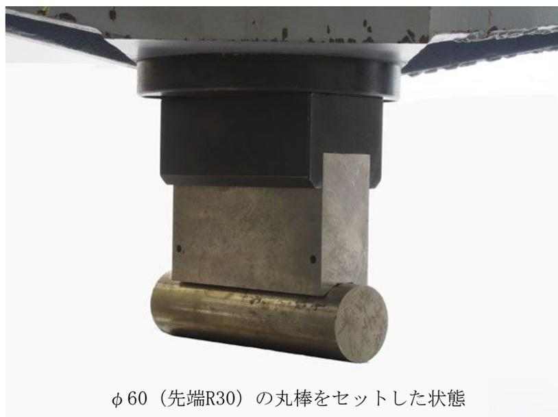
先端に曲率を持たせた押しジグの場合、荷重位置を特定しやすいという利点がありますが(例えば、曲げ試験において、支点位置から荷重位置までの距離を特定しやすい)、試験体との接触形態が点接触または線接触となるため、押しジグが損傷しやすいという欠点があります。
