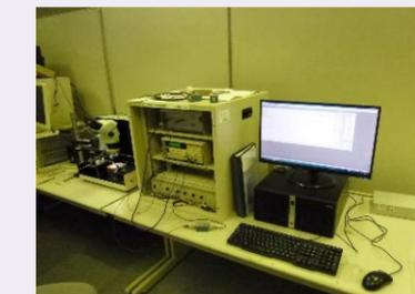
強誘電体の分極ヒステリシス特性やリーク電流特性等が測定できます。±200Vまでの高電圧が印加できます。強誘電体の分極処理が可能です。
