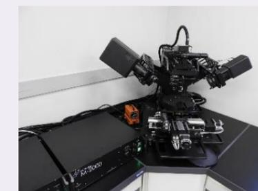
薄膜の屈折率、消衰係数、膜厚等を非破壊で測定できます。
