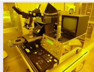
シリコン基板や硝子基板等の各種基板にマスクの微細パターンを転写する装置です。基板両面に転写できます。
