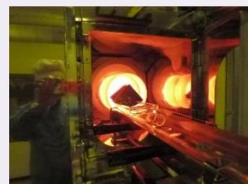
シリコン基板の熱酸化、シリコン基板上にシリコン窒化膜、ポリシリコンの成膜が可能です。
