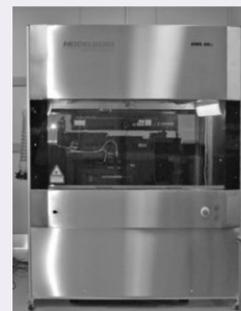
クロムマスクへの微細パターンの作製が可能です。各種基板への微細パターンの直接描画も可能です。
