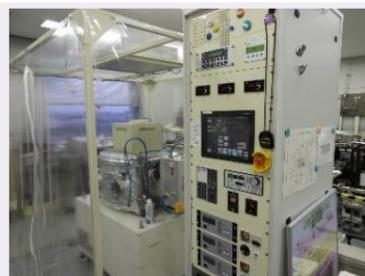
各種基板上に薄膜を成膜する装置です。同一真空下で3種類の材料の積層薄膜の作製が可能です。多くの材料に対応できます。
