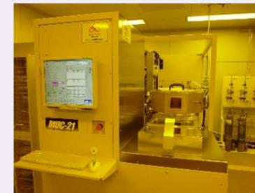
シリコン基板を高速に垂直に深掘りできます。最大8インチの基板に対応できます。
