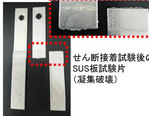
せん断接着試験後のSUS板試験片(凝集破壊)
