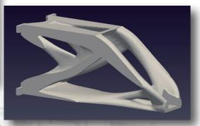
金属AMは、金属3Dプリンティング、金属積層造形とも呼ばれ、3D-CADデータに基づいて1層ずつ積み上げながら三次元の金属構造体を造形する加工法です。従来工法では実現困難な複雑形状を比較的短時間で造形できるため、近年注目を集めています。
